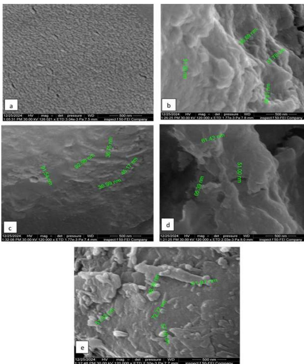
Figure 3. FESEM images for (CMC/ZnSe) nanocomposites:(a) for (CMC) pure, (b) for 2 wt.% ZnSe, (c) for 4 wt.% ZnSe, (d) for 6wt.% ZnSe, (e) for 8 wt.% ZnSe.
